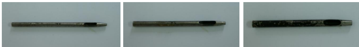
ภาพ ๗.๑ ก สั้วเจาะรูหรือตุ้ดตุ้ ขนาดเล็ก กลาง ใหญ่
