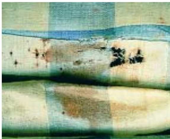
ผ้าเกิดการชำรุดเสื่อมสภาพเนื่องจากคราบสีน้ำตาลที่เกิดจากสารเติมแต่ง
